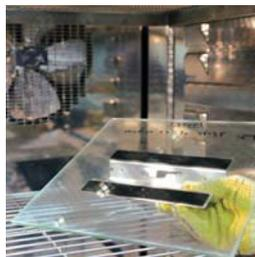
**Exklusive Anwendungstests:** In den anwendungstechnischen Laboren analysiert tesa die Materialien des Kunden in Kombination mit unterschiedlichen Klebebandlösungen. Abhängig von den kundenspezifischen Anforderungen werden hierbei UV- und Temperatur-Beständigkeit, Verklebungsfestigkeit, Schockabsorption, Spannungsausgleich und vieles mehr getestet. Das Ergebnis sind Klebebandlösungen, die perfekt auf die jeweilige technische Anwendung zugeschnitten sind.
